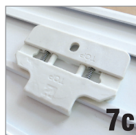
Abb. 7b - 7c: Profil in den Clip einklicken. Dazu die Federn etwas zusammendrücken.
